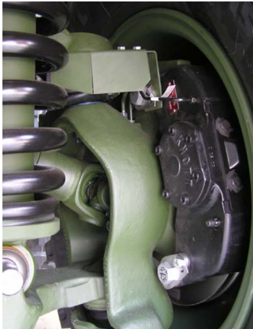
Bild 2: Einbausituation des Bremssattels an der Hinterachse: Auf engstem Raum perfekt eingepaßt!
